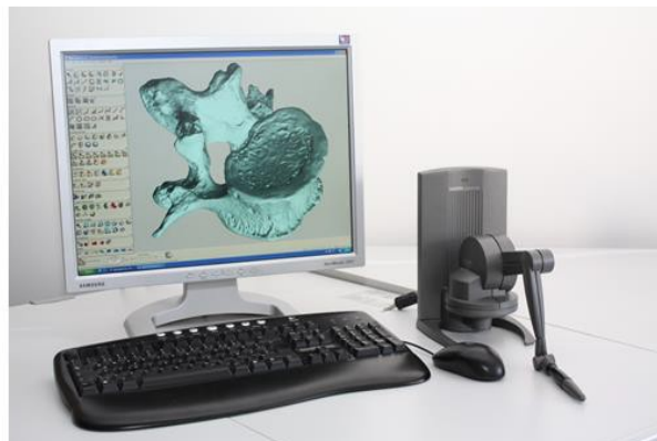
Abb. 3. Hybrid-Modeller Geomagic Freeform mit Eingabegerät Touch X.
