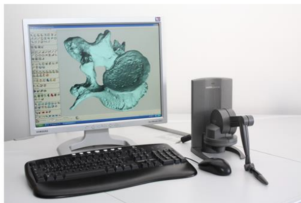
Abb. 3. Hybrid-Modeller Geomagic Freeform mit Eingabegerät Touch X.
